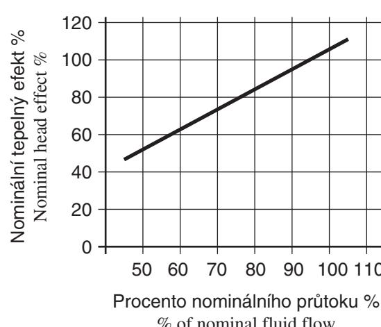
**Parametry výměníku:** Tepelný výkon je udaný pro teplotní rozdíl 60 °C mezi vstupní topnou a vstupní ohřívanou vodou.
