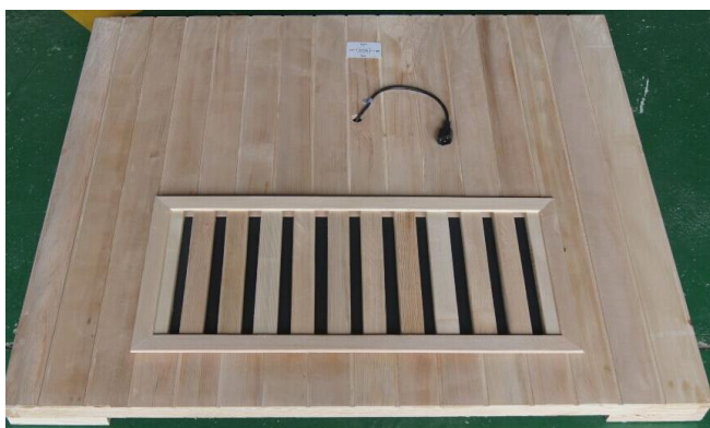
Foto č. 1 – Podlaha připravená k montáži stěn
