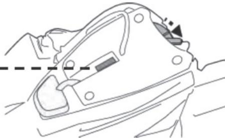
**3.** Posuňte vypínač do polohy „ON“ (když je robot stále ponořen) - rozsvítí se kontrolka a automaticky se aktivuje motor (hladina vody zakrývající senzory v horní části otočné hlavy). Nechte robota klesnout na dno bazénu a sledujte jeho první pohyby dopředu a dozadu přes dno bazénu. Pokud místo kolmo vede podél stěny bazénu, vytáhněte jej a znova nasadte, přičemž se ujistěte, že jeho přední / zadní strana směřuje ke stěně bazénu
