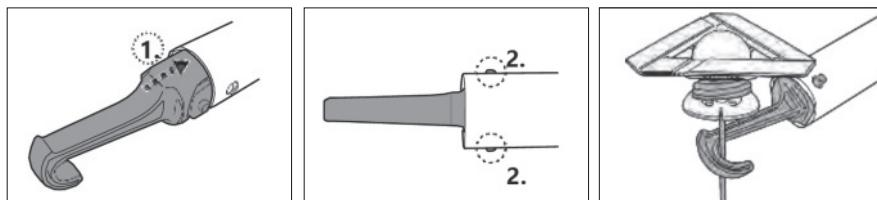
Akonáhle robot dosiahne vodnú hladinu, nájdite úchop, ktorý je pod základňou a je označený symbolom ruky (viď obrázok nižšie), aby ste uľahčili vytiahnutie z bazéna. Uistite sa, že vždy uchopíte robota za túto časť, aby sa zabránilo vypadávaniu nečis-tôt späť na bazéne.
