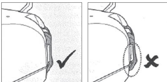
**TIPY:** Před opětovným umístěním vysavače do bazénu "zkontrolujte, zda jsou spony řádně zajištěné proti oddělení spodní a horní části vysavače."
