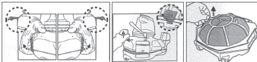
**2. Vyndejte kryt filtru a odstraňte nečistoty z prostoru. Doporučuje se čistit síť filtru proudem vody. Pokud je považováno za nutné kartáčování, čistěte jej opatrně a jemně pouze měkkým kartáčem, aby nedošlo k poškození.**
