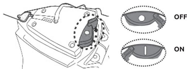
2. Připojte nabíjecí kabel externího adaptéru k nabíjecímu kabelu. Otevřete ochranný kryt. Zarovnejte a zasuňte zástrčku nabíjecího kabelu do nabíjecího portu v horní části jednotky.
