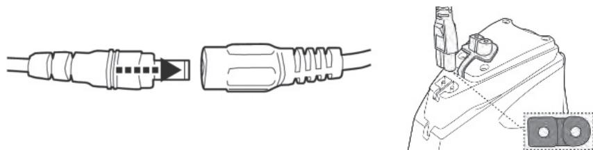
**3.** Pripojte externý adaptér k zdroju napájania. Akonáhle začne nabíjanie, kontrolka na externom adaptéri sa rozsvieti na červeno. Ked' je robot nabitý, kontrolka na externom adaptéri sa rozsvieti na zeleno.
