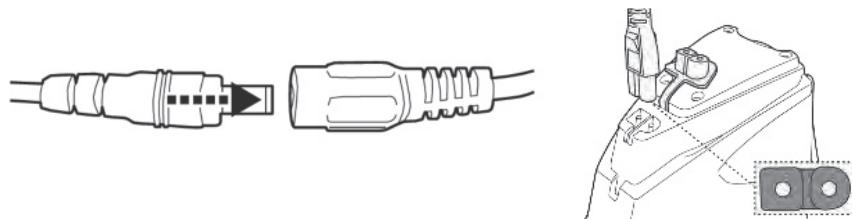
**3.** Připojte externí adaptér ke zdroji napájení. Jakmile začne nabíjení, kontrolka na externím adaptéru se rozsvítí červeně. Když je robot nabitý, kontrolka na externím adaptéru se rozsvítí zeleně.
