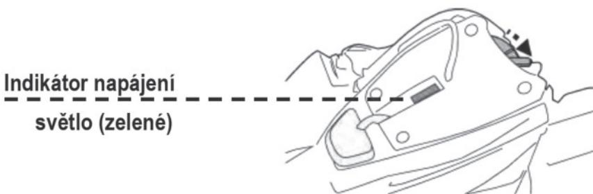
**3.** Posuňte vypínač do polohy „ON“ (ked‘je robot stále ponorený) - rozsvieti sa kontrolka a automaticky sa aktivuje motor (hladina vody zakrývajúca senzory v hornej časti otočnej hlavy). Nechajte robota klesnúť na dno bazéna a sledujte jeho prvé pohyby dopredu a dozadu cez dno bazéna. Ak miesto kolmo vedie pozdĺž steny bazéna, vytiahnite ho a znova nasadťte, pričom sa uistite, že jeho predná / zadná strana smeruje k stene bazéna
