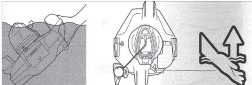
5. Vypnite robota. Po každom použití opláchnite robota čerstvou vodou.
