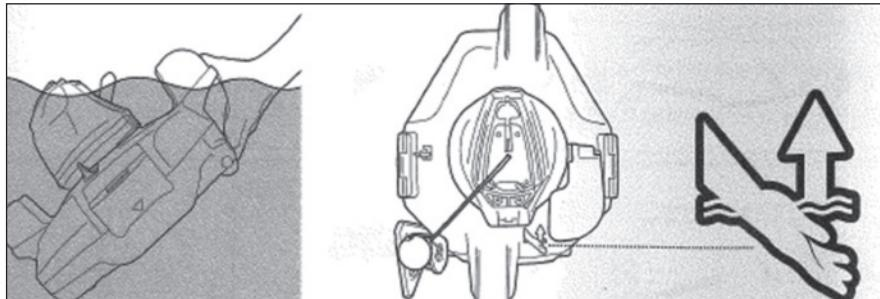
5. Vypněte robota. Po každém použití opláchněte robota čerstvou vodou. NEPOUŽÍVEJTE žádný čistící prostředek.
