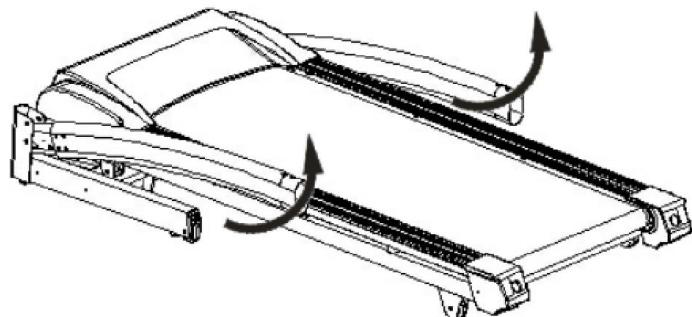
KROK 2: Pro spojení trubic s podstavou použijte šrouby M8x15 (76) a M8x45 (75). Připevněte boční kryty (57), (27) pomocí šroubů M4x10. Pro připojení držáku lahve (95) k trubici použijte šroub (96) a plochou podložku (97).
