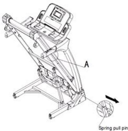
Pokud stroj potřebujete složit řídte se následujícími instrukcemi a obrázkem. Chytněte rám a zatáhněte za pružný kolíček. Zvedněte desku nahoru dokud neuslyšíte zacvaknutí.
