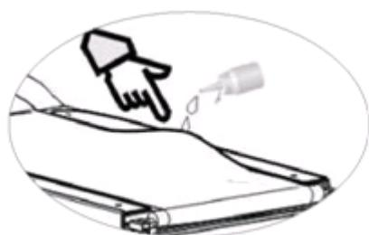
Po aplikaci mazání stroj opět rozložte a pust'te pás na rychlosť 1Km/h. Poté šlapejte jednou nohou na pás po dobu několika minut, aby pás pořádně vstřebal lubrikant.
