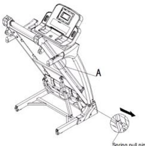
Pokud stroj složit říd'te se následujícími instrukcemi a obrázkem. Chytněte rám a zatáhněte za pružný kolíček. Zvedněte desku nahoru dokud neuslyšíte zacvaknutí. potřebujete
