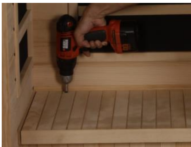
Foto č. 22 – přišroubování držáku na noviny Foto č. 23 – přišroubování sedáku lavice
