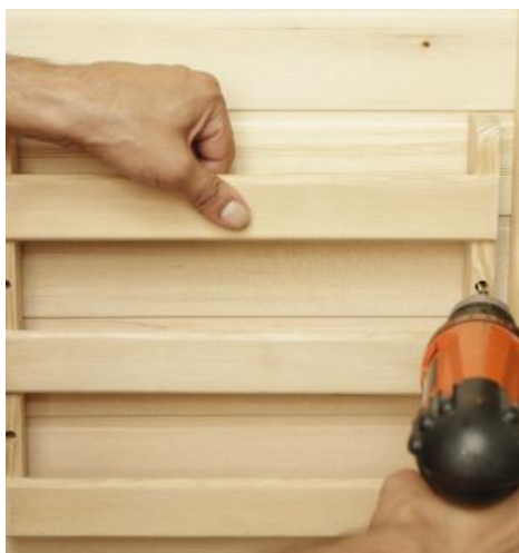
Foto č. 22 – přišroubování držáku na noviny Foto č. 23 – přišroubování sedáku lavice
