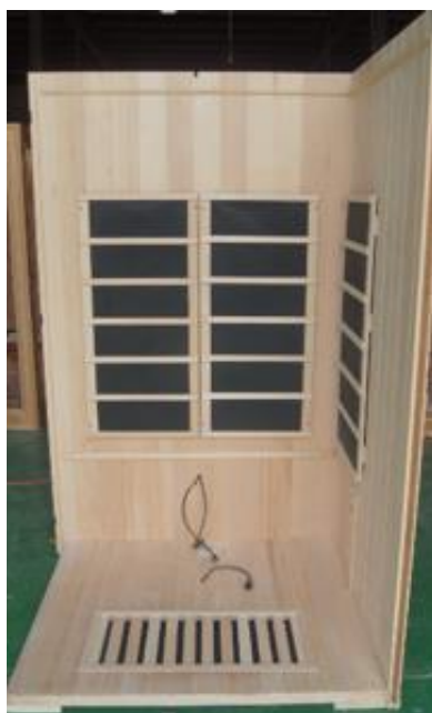
Foto č. 3 – Podlaha osazená zadní a pravou stěnou
